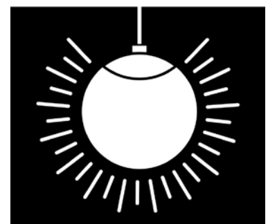
Rys. 4. Oprawa przy oświetleniu półpośrednim
