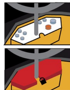
Rys. 6. Zabezpieczenie elementów sterowniczych maszyny
