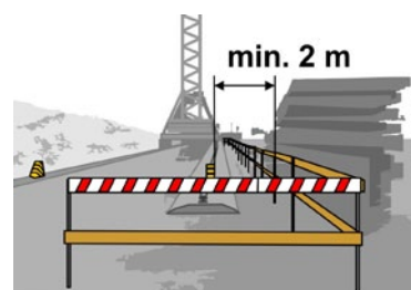
Rys. 7. Wygradzanie torowiska żurawi szynowych
