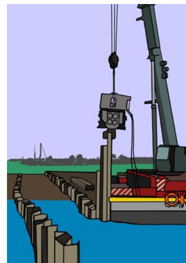
Rys. 5. Stabilizacja maszyny na podłożu podmokłym i bagnistym
