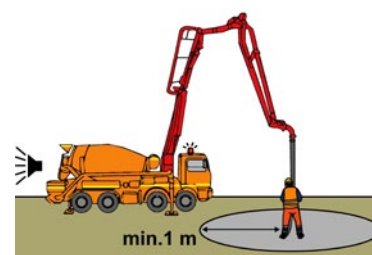
Rys. 2. Zachowanie bezpiecznej odległości przy pracach pompy do betonu
