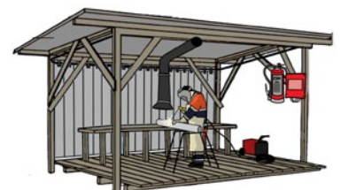
Rys. 1. Stanowisko spawalnicze na otwartej przestrzeni
