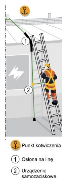
Rys. 3. Bezpieczne wejście na dach
