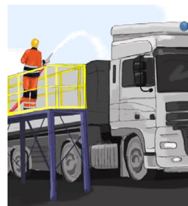
Rys. 3. Rampa do plandekowania pojazdów
