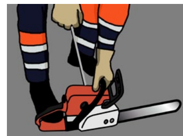
Rys. 2. Prawidłowy sposób pracy z pilarką łańcuchową – uruchomienie
