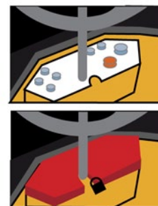
Rys. 6. Zabezpieczenie elementów sterowniczych maszyny
