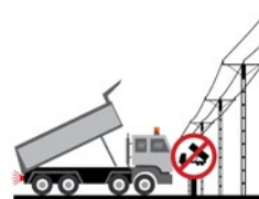
Rys. 5. Zakaz podnoszenia skrzyń ładunkowych w sąsiedztwie napowietrznych linii energetycznych
