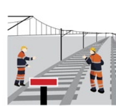
Rys. 2. Wyłączenie i oznakowanie toru kolejowego
